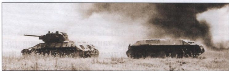
Эвакуация с поля боя подбитого Т-34 инженерным танком (Т-34 без башни)
